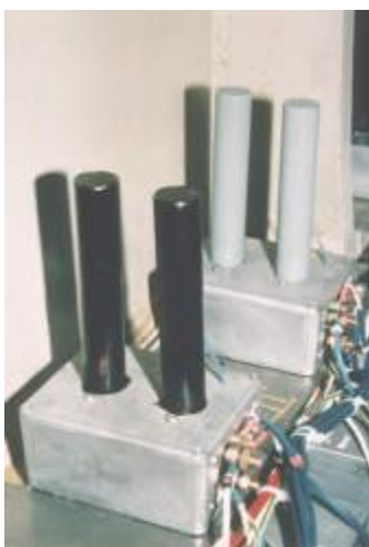
Рис. 6 - Пиролизер для установки в генераторе
